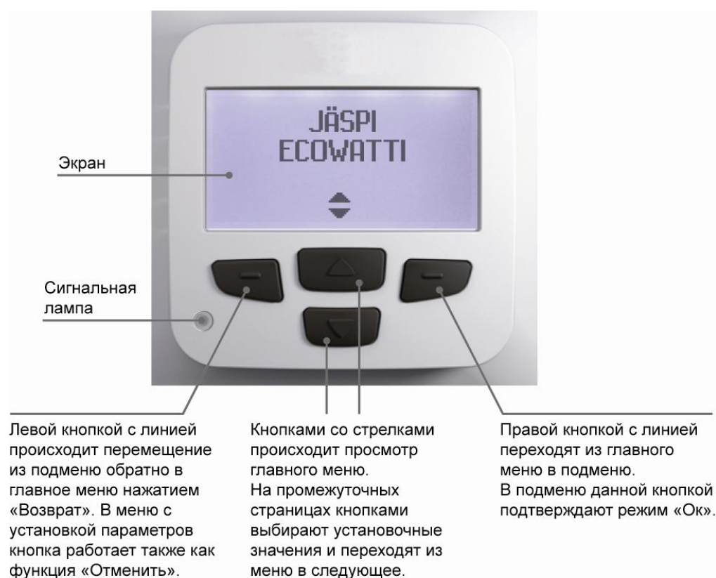
Рис. 21 Есо M09 – блок регулировки.
