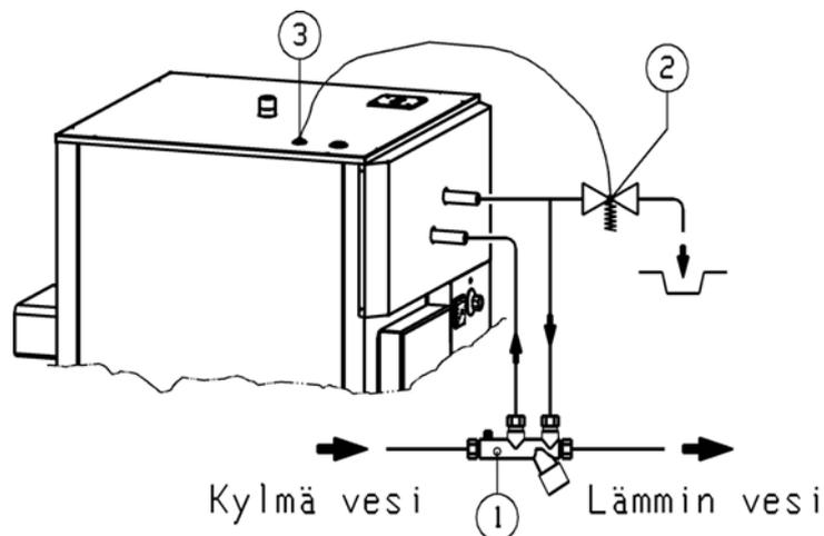
**Рис 2.** Подключение термического (напр. Jäspi-TSK) клапана против выкипания к змеевику ГВС.
