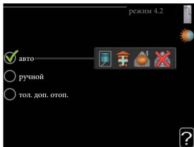
Рабочий режим теплового насоса обычно установлен на "авто". Также можно установить тепловой насос на "тол. доп. отоп.", но только в случае использования дополнительной мощности, или "ручной" и самостоятельно выбрать разрешенные функции.
