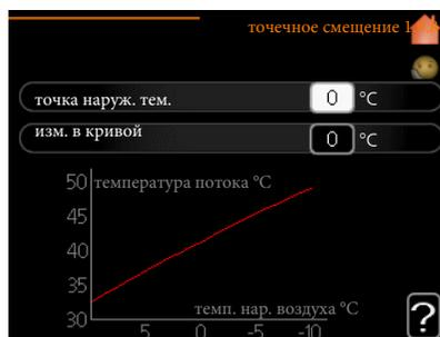
Здесь выбирается изменение кривой нагрева при определенной наружной температуре. Чтобы изменить температуру в помещении, обычно достаточно одного шага, но в некоторых случаях может понадобиться несколько шагов.
