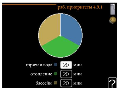
Здесь выбирается длительность работы теплового насоса по каждому требованию при одновременном наличии нескольких требований. При наличии только одного требования тепловой насос работает только согласно этому требованию.
