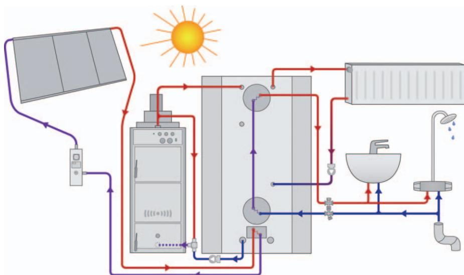
Примеры подключения систем на солнечной энергии. Не применяются в качестве точных схем монтажа.
