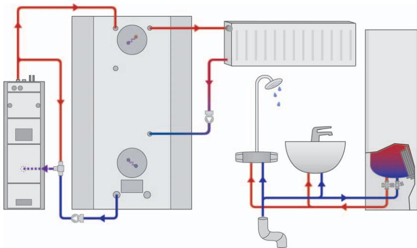
Jäspi Econature с теплоаккумулятором и дополнительным источником энергии в виде электротэнев или теплового насоса
